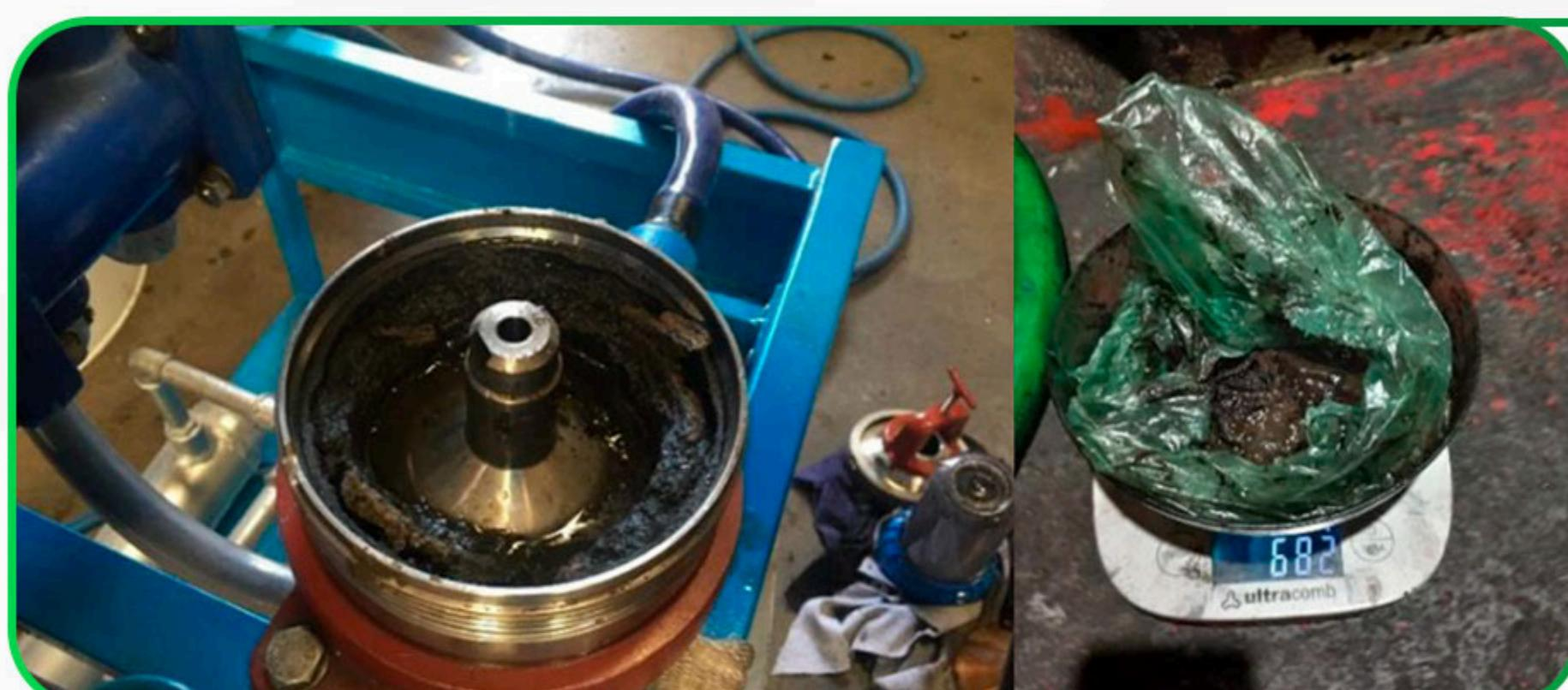
Clarificación con extracción de partículas mayores a un micrón en 4000 lts de SAE 68 resultado: 680 gr de partículas suspendidas
